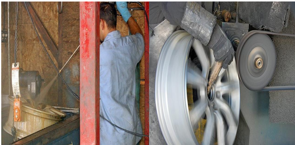
Рисунок 2.3 – Процесс удаления красок и механическая шлифовка поверхности дисков
