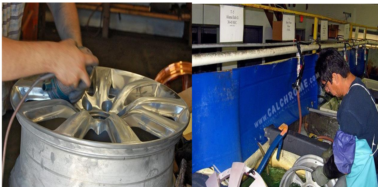
Рисунок 2.4 – Финальная полировка и травление поверхности в химической ванне
