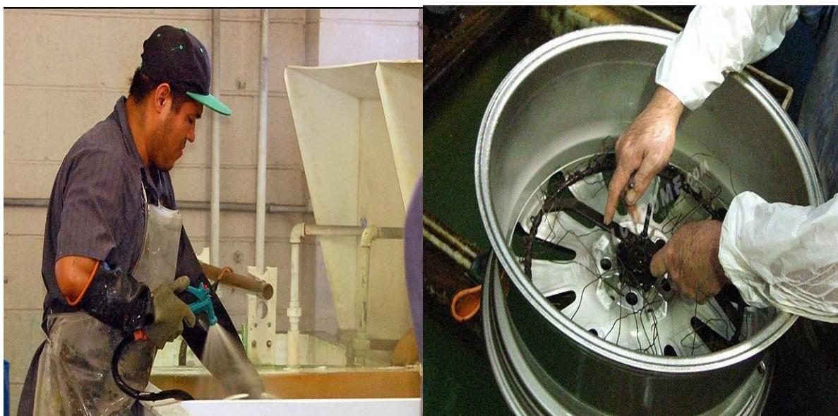
Рисунок 2.5 – Нанесение никелевого подслоя и промывка диска
