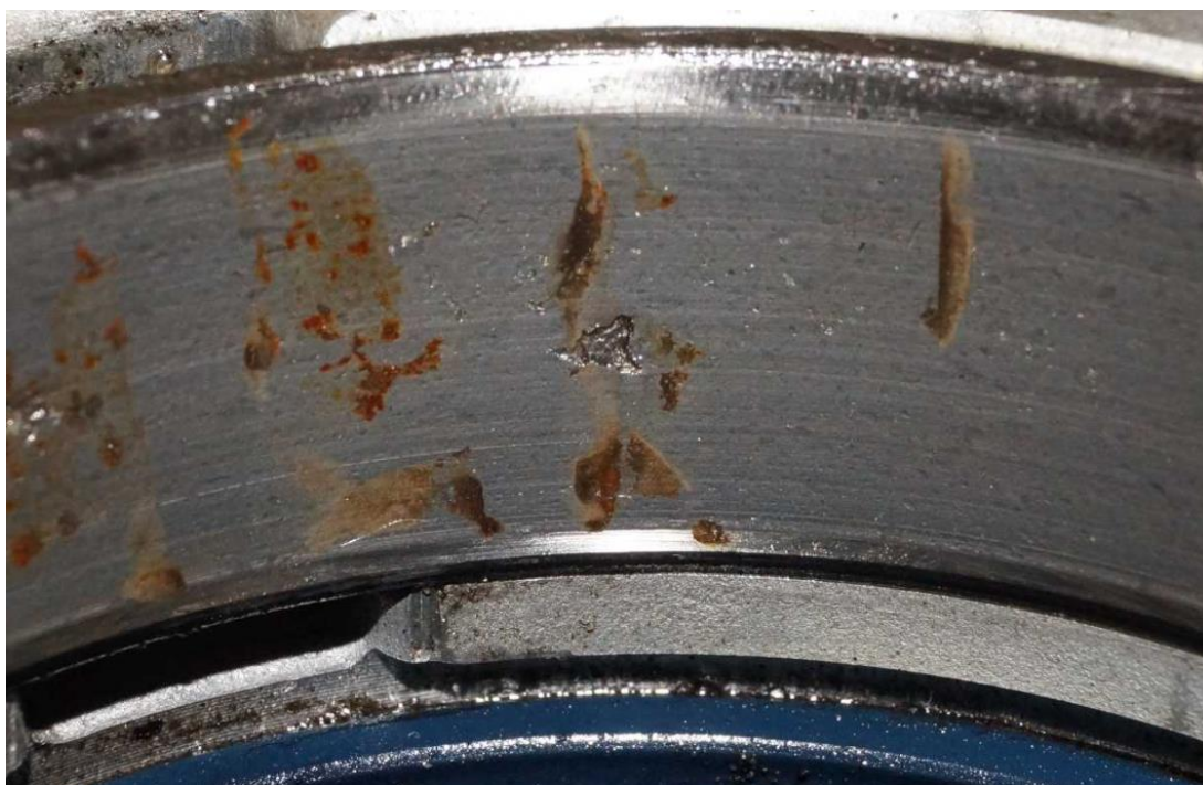
Рисунок 1.8 – Скол из-за гидроабразивного износа на подшипнике колеса
