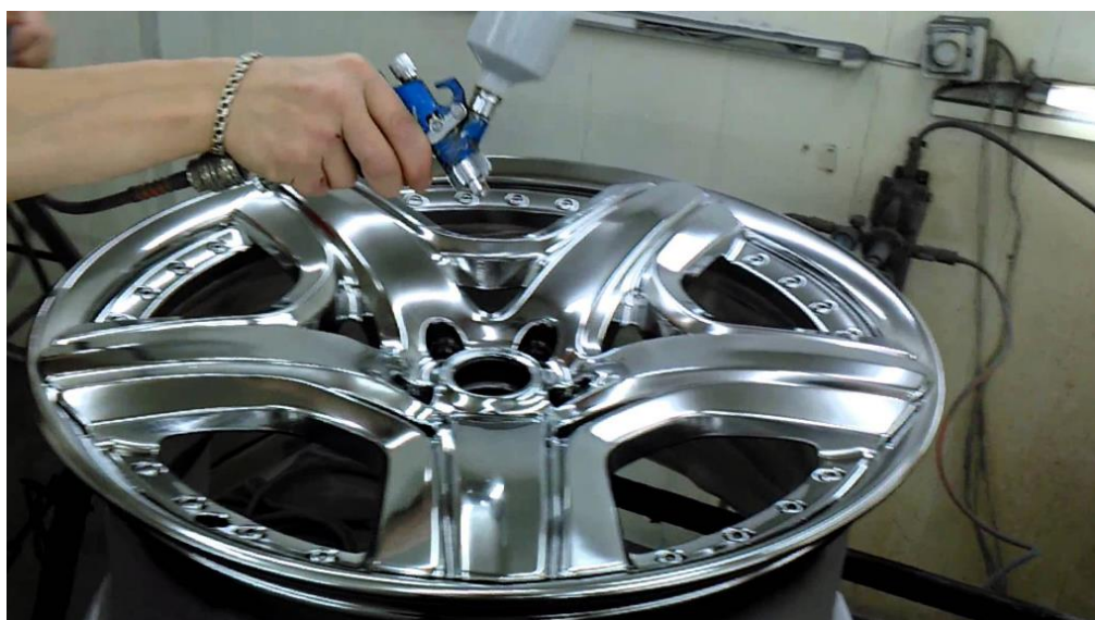
Рисунок 2.1 – Процесс хромирования дисков
