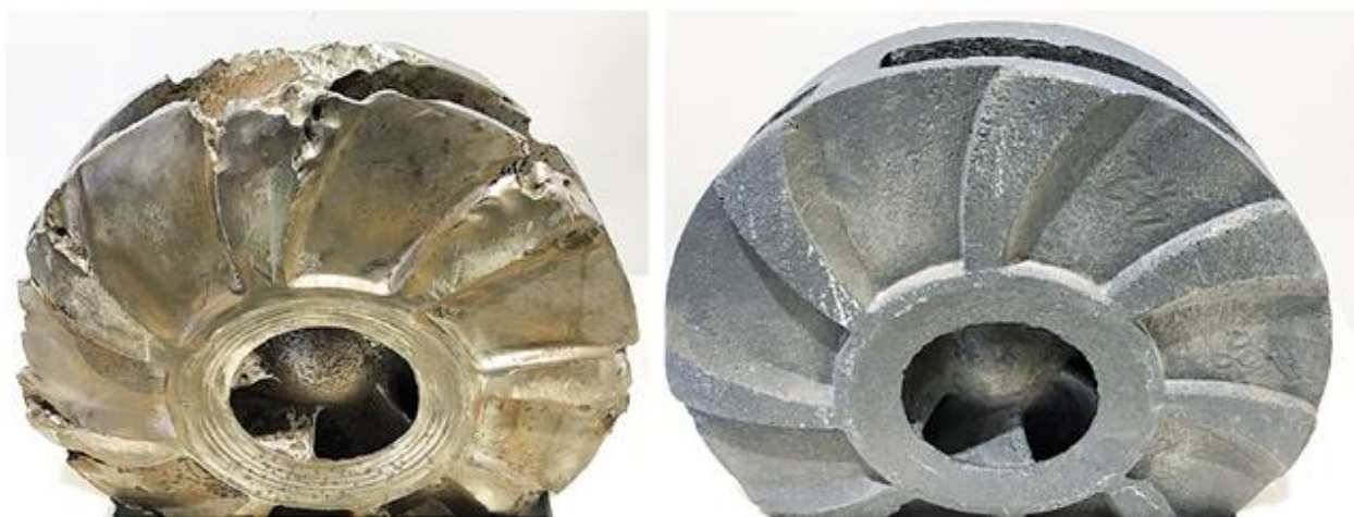
Рисунок 1.3 – Последствия гидроабразивного износа
